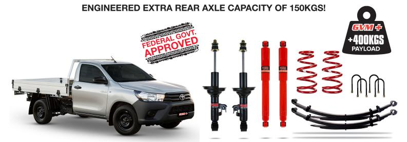
Designed to suit: Toyota Hilux SR GUN123R 2 door Cab Chassis & 4 door Ute. Toyota Hilux Workmate GUN122R 4 door Ute & 2 door Cab Chassis. Toyota Hilux SR GGN120R 4 door Ute & Toyota Hilux Workmate TGN121R 4 door Ute & 2 door Cab Chassis.
